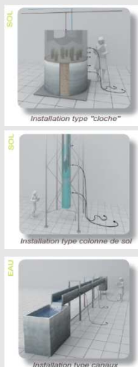
Exemple d'organisation d'une halle expérimentale avec dispositifs scientifiques
